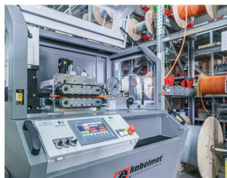
Abb. 3 Bedienpult mit Touchpanel-Steuerung und geregeltm Positionier-Servoantrieb
