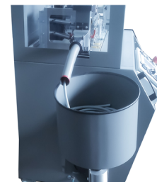
Abb. 5 Topfwickler mit regelbarem Antriebsmotor
