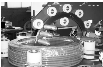
Abb. 8 Einwickelstation für Stretchband
