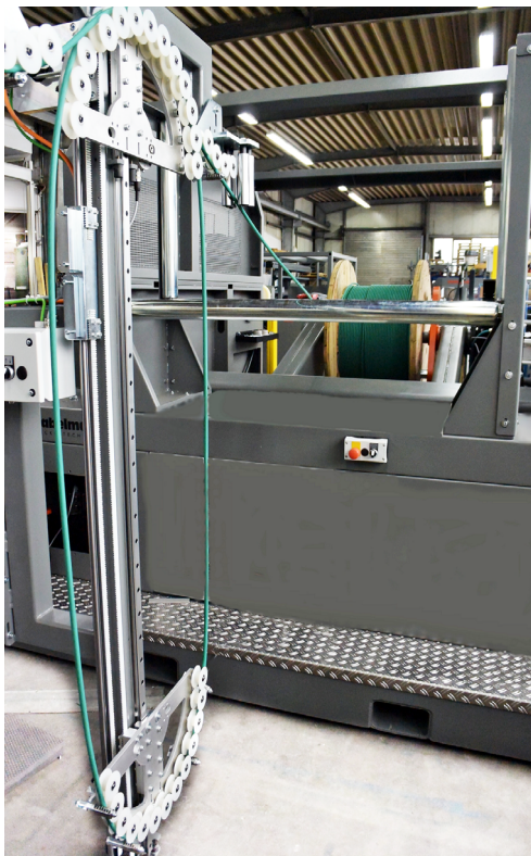
Abb. 2 ACUMATIC: Materialspeicher / Tänzer zur Steuerung und Synchronisation des Antriebes der Wickelmaschine. Dieser ist bei zugempfindlichen Wickelgütern erforderlich.
